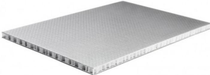
Materiale high-tech a nido d'ape in PP (polipropilene) Dalla particolare lavorazione del materiale grezzo risulta un pannello che, in relazione al peso, è estremamente stabile e resistente alla torsione. La superficie del pannello è protetta da un sottile strato di PET, che assicura un'elevata resistenza ai raggi UV e buone proprietà di adesione del materiale.
