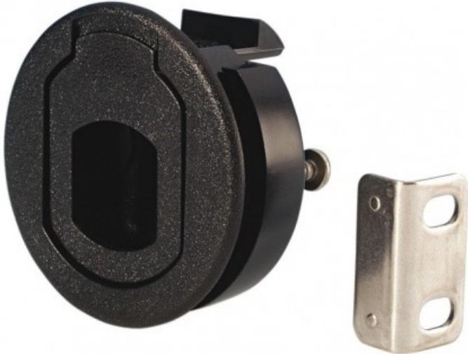
Fermo leva a incasso per sportello di servizio di plastica nero (POM). Per il montaggio in spessori legno di 7-13 mm. Viti di acciaio inossidabile.
