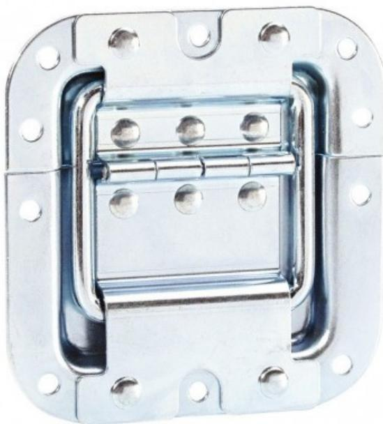
**Materiale piatto acciaio** **Superficie piatto zincato** **Tipo piatto a gomito** **Metodo di costruzione** Con cerniera **Funzione "Clic Stop"** **No Dimensione piatto medio** **Profondità piatto 8 mm** **Design protezione rivetti** **No Ø fori di montaggio** **5,1 mm** **Sganciabile** **No Peso 0,22 kg**
