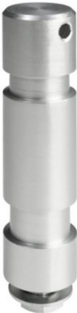
SLSTV28M10 è un perno per TV in alluminio con diametro di 28 mm, lunghezza di 115 mm e filettatura interna M10 con 34 mm di profondità. Realizzato in alluminio lucido e fornito con vite esagonale M10, rondella e rondella elastica.
