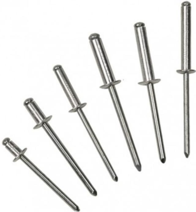
**Ø rivetto** 4 mm **Lunghezza rivetto** 16 mm **Ø testa** 8 mm **Altezza testa** 1,4 mm **Ø mandrino** 2,2 mm **Campo di serraggio** 10,5 - 12,5 mm **Capacità di carico fermo** 1250 N **Capacità di carico trazione** 1800 N **Materiale rivetto** Alluminio **Lega rivetto** AlMg 3,5 **Materiale mandrino** acciaio **Superficie mandrino** zincato **Peso** 0,003 kg
