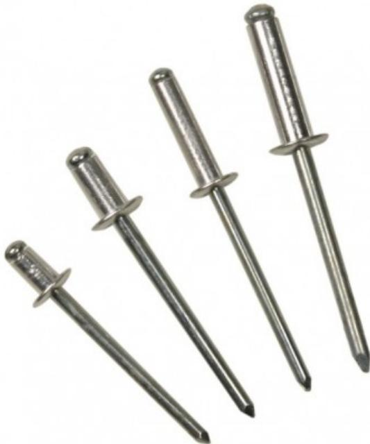
**Ø rivetto**4,8 mm**Lunghezza rivetto**18 mm**Ø testa**9,5 mm**Altezza testa**1,4 mm**Ø mandrino**2,73 mm**Campo di serraggio**12,0 - 14,0 mm**Capacità di carico fermo**2000 N**Capacità di carico trazione**2700 N**Materiale rivetto**Alluminio**Lega rivetto**AlMg 3,5**Materiale mandrino**acciaio**Superficie mandrino**Grezzo**Peso**0,0032 kg
