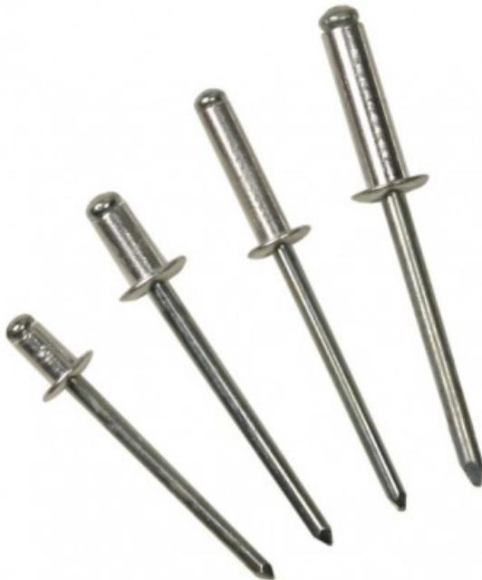
**Ø rivetto**4,8 mm **Lunghezza rivetto**21 mm **Ø testa**9,5 mm **Altezza testa**1,4 mm **Ø mandrino**2,73 mm **Campo di serraggio**14 - 17 mm
