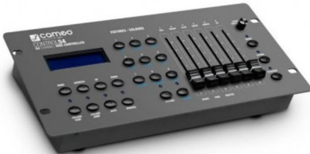
Il Control 54 è un compatto mixer luci DMX che può controllare fino a 9 fari o gruppi di fari. Il versatile controller può essere gestito in modo semplice e intuitivo ed è ideale per DJ, club, bar o foyer. È dotato di 9 preset cromatici i cui tasti di selezione possono essere utilizzati anche per la selezione dei fari, 6 fader per la regolazione individuale delle proporzioni di rosso, verde, blu, bianco, ambra e UV.
