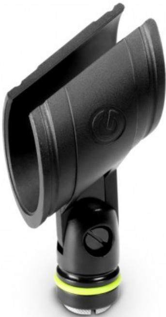
Questa clip è adatta a radiomicrofoni palmari con impugnatura del diametro di 34-42 mm. La clip infrangibile in plastica elastica di alta qualità sostiene il microfono in modo sicuro e si può inclinare per orientarlo nell'esatta posizione desiderata. Grazie alla sua filettatura interna da 5/8" e all'adattatore da 3/8" in dotazione, è adatta a tutti gli stativi e alle aste giraffa per microfoni
