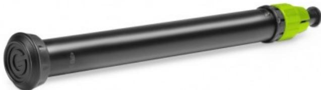
I supporti per casse e per luci possono essere installati in sicurezza anche su superfici irregolari o inclinate, persino su gradini e scale. La gamba livellante Gravity VARI-LEG 01® è estraibile in continuo fino a 25 cm. È adatta a tutte le gambe aventi un diametro interno compreso tra 33 a 37 mm (eccetto la serie touring), può essere montata rapidamente e facilmente senza attrezzi e, se non è richiesta alcuna compensazione della lunghezza delle gambe, può rimanere applicata al supporto.
