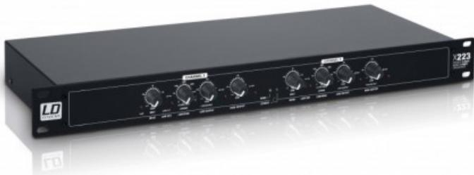
LD Systems X223 è un crossover in formato rack standard (19"/1 U) che permette una suddivisione del segnale su 2 vie (stereo) o 3 vie (mono). Questo crossover si contraddistingue per la robustezza del corpo, l'elevata qualità, la stabilità degli elementi di controllo e un alimentatore integrato, caratteristiche non certo scontate nella sua classe di prezzo.
