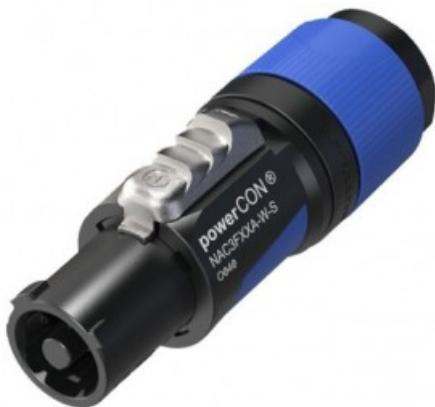
Connettore bloccabile per cavo di rete CA, codificato con chiave e colore (blu) per l'alimentazione, montaggio con terminale a vite, per cavi di diametro compreso tra 6 e 12 mm.
