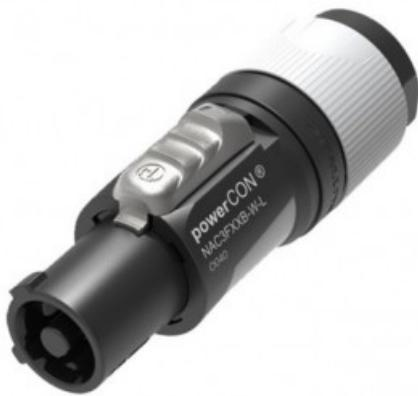
Connettore bloccabile per cavo di rete CA, codificato a chiave e a colori (grigio) per l'uscita di corrente, con terminale a vite, per cavi di diametro compreso tra 10 e 16 mm.
