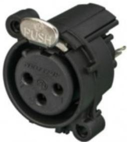
Prese da pannello all'avanguardia in un alloggiamento rotondo di plastica. Queste prese con le più piccole dimensioni di installazione offrono una densità di imballaggio molto alta (23 mm tra i centri del connettore), contatti a tulipano placcati in oro duro di nuova concezione e punti di contatto lucidati. Componente riconosciuto UL.
