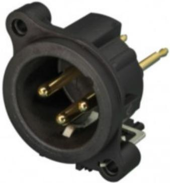
Presa XLR maschio a 3 poli, messa a terra: contatto di terra separato al guscio del connettore e al pannello frontale, versione verticale per montaggio su PCB.
