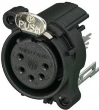
**Numero di poli**5 **Colore**Nero **Contatti**Bronzo **Tipo di collegamento**Montaggio verticale su scheda **Presa di collegamento**7 **Resistenza di isolamento**>10 **Corrente nominale per contatto**3 A **Cassa**Poliammide **Forma del telaio**A **Chiusura**Dispositivo di bloccaggio **Classe di infiammabilità**UL 94 HB **Classe di protezione IP**40 **Range di temperatura**-30 - 80 °C **Peso**0,007 kg
