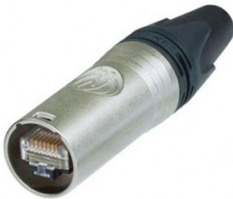
Il set di connettori a innesto NE8MX6 è costituito da un robusto alloggiamento in metallo, dal collaudato scarico della trazione con bussole di chiusura e da un connettore RJ45 conforme a CAT6A. NE8MX6 è indicato per cavi con un diametro compreso tra 7 e 9,5 mm e una sezione cavo di AWG24/1 - AWG22/1 (filo) o AWG24/7 - AWG22/7 (cavetti). Abbinata alle prese da pannello NE8FDX-P6-W o NE8FDX-Y6-W, questa variante è impermeabile secondo IP65.
