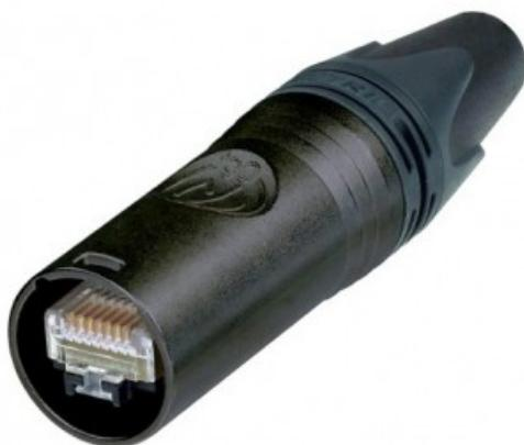
Il set di connettori cavo NE8MX6-B è costituito da un robusto alloggiamento in metallo, dal collaudato scarico della trazione con bussole di chiusura Neutrik e da un connettore RJ45 conforme a CAT6A. NE8MX6 è indicato per cavi con un diametro compreso tra 7 e 9,5 mm e una sezione cavo di AWG26/1 - AWG22/1 (filo) o AWG27/7 - AWG22/7 (cavetti). Abbinata alle prese da pannello NE8FDX-P6-W o NE8FDX-Y6-W, questa variante è impermeabile secondo IP65.
