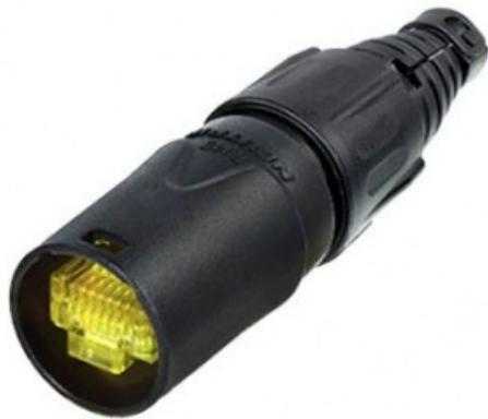
La protezione per connettori cavo RJ45 preconfezionati è composta da un alloggiamento cromato nero, disco di battuta, bussola di chiusura, bussola di serraggio e protezione antipiega. È fornita con due elementi antipiega per cavi di diametro da 5 mm a 8 mm. Connettore cavo RJ45 non compreso nella fornitura.
