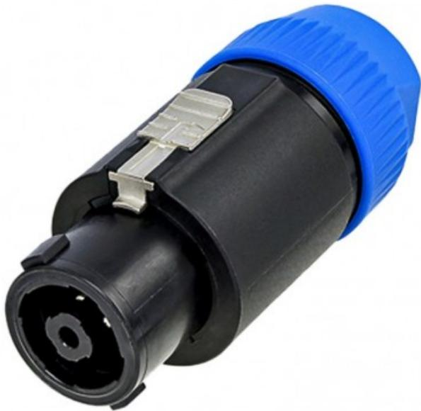
Presa cavo a 8 poli con bloccaggio, bussola di chiusura integrata per cavo di diametro compreso tra 8 e 20 mm, corrente nominale di 30 A per contatto
