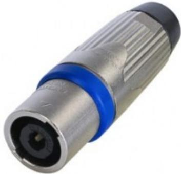
**Numero di poli**4 **Diametro cavo**9 - 16 mm **Contatti**Rame **Tipo di collegamento**Contatti a saldare **Colore**Argento **Cassa**Colata di zinco **Scarico trazione**Poliacetale **Lunghezza**83 mm **Diametro**26 mm **Peso**0,07 kg
