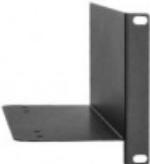
Questo kit comprende due staffe in acciaio per rack rifinite con un'elegante verniciatura a polveri nera utilizzate per montare Palmer Supreme Soaker su un rack standard da 19?. Per montare le staffe da rack, per prima cosa allentare le viti che fissano i piedini del Supreme Soaker, quindi staccare i piedini. Con le stesse viti, fissare quindi le staffe da rack all'apparecchiatura insieme ai piedini.
