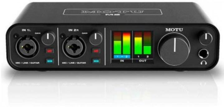
Interfaccia audio USB a 2 canali. Convertitore AD/DA a 24 bit/192 kHz. 2 preamplificatori microfonici con alimentazione phantom 48 V selezionabili individualmente su ciascuno. 2 ingressi di linea: combo XLR/Jack da 6,3 mm selezionabile per ingresso dello strumento HiZ.
