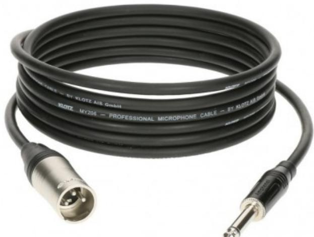
Cavo per microfono Guaina in PVC ultra flessibile con spirale protettiva Connessione XLR Klotz a 3 punti su jack Amphenol a 2 punti Sbilanciato XLR maschio/jack maschio Lunghezza 10 metri
