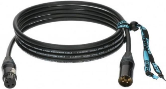
Cavo per microfono HiFi di alta qualità. Suono estremamente trasparente. Bassi extra ricchi. Doppia spirale protettiva in rame Nucleo in PVC per stabilizzare i conduttori. Con bassissima perdita di trasmissione. Connessione Neutrik XLR a 3 punti con contatti placcati in oro. Cappuccio in metallo nero. Capacità ultra bassa di 55 pF/m. Diametro 7 mm. Maschio/femmina. Lunghezza 6 metri.
