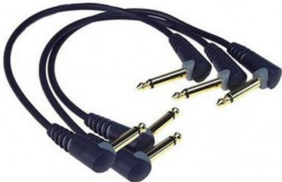
Cavi patch per pedali Rivestimento in PVC antinodo con cavo a 24 punti 4,5mm Connessione jack placcata oro con 2 punti di contatto Sbilanciati In confezioni da 3 unit Jack angolato/angolato Lunghezza 0,90 metri
