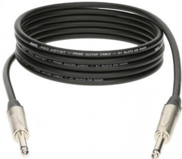
Cavo per strumenti Guaina in PVC con doppia protezione, 6,5mm antinodo Connessione jack Neutrik 6,35mm a 2 punti Capacit ultra bassa di 95 pF/m Jack dritto/dritto Lunghezza 3 metri
