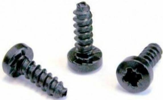
Vite autofilettante PLASTITE®\* nera, configurazione triangolare, 2,9 x 1,05, con testa bombata, lunghezza 8 mm, adatta alle serie A, AA, Combo e speakON. \*PLASTITE® è un marchio registrato di SFS Unimarket.
