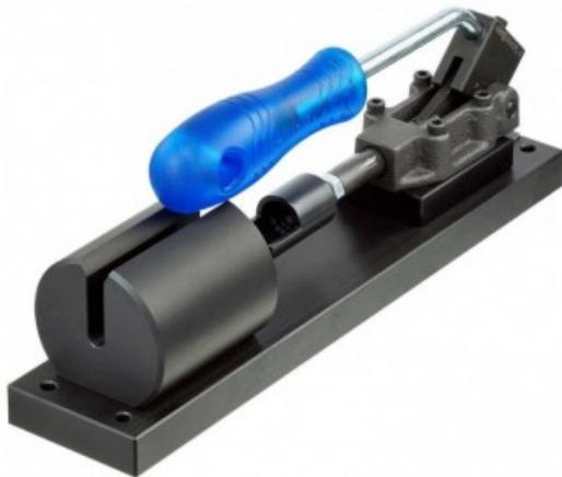
Attrezzo per il montaggio del baule di velocità per premere il baule XX sull'alloggiamento.
