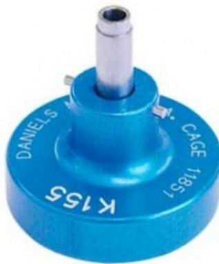
Posizionatore DMC modificato (K155) per MPC (contatto maschio a crimpare MINICON CONNECTOR). Il posizionatore di contatto mantiene il contatto in posizione durante la crimpatura. Standard di crimpatura: No. 5 / M22520/2-01
