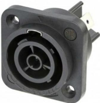
Il powerCON TRUE1 TOP è un connettore a corrente reale da 16 A con blocco per applicazioni esterne. Sostituisce gli accoppiatori per elettrodomestici ogni volta che è necessaria una soluzione molto robusta in combinazione con un dispositivo di bloccaggio per garantire una connessione elettrica sicura. Il powerCON TRUE1 TOP è un connettore con capacità di interruzione (CBC), cioè può essere collegato o scollegato sotto carico o sotto tensione.
