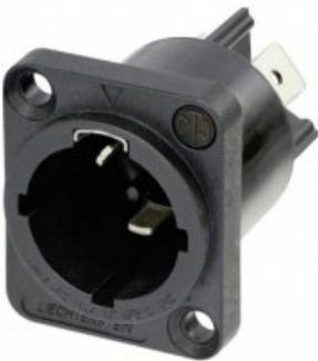
Il powerCON TRUE1 TOP è un connettore a corrente reale da 16 A con bloccaggio per applicazioni esterne. Sostituisce gli accoppiatori per apparecchi quando è necessaria una soluzione molto robusta in combinazione con un dispositivo di bloccaggio per garantire una connessione elettrica sicura. powerCON TRUE1 TOP è un connettore con capacità di interruzione (CBC), cioè può essere collegato o scollegato sotto carico o sotto tensione.
