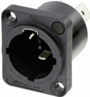
Connettore di ingresso per apparecchi, terminali reed piatti da 1/4 , senza distanziatore di isolamento.powerCON TRUE1 TOP è un connettore a corrente reale da 16 A con blocco per applicazioni esterne. Il powerCON TRUE1 TOP è un connettore con capacità di rottura (CBC), cioè può essere inserito o disinserito sotto carico o sotto tensione.
