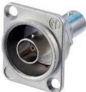
Connettori BNC a telaio con messa a terra, foro passante in alloggiamento in nichel a forma di D. I connettori Neutrik BNC a telaio offrono un vero design a 75 Ω per segnali seriali e digitali (HD). Il corpo del connettore, in ottone lavorato, garantisce un collegamento estremamente robusto e non abrasivo durante l'uso a lungo termine ed è inoltre incassato e quindi ben protetto in un alloggiamento a forma di D (standard del settore audio).
