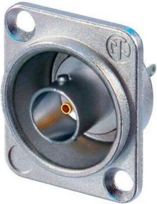
Connettori BNC a telaio isolati, versione a saldare con alloggiamento in nichel a forma di D. I connettori Neutrik BNC a telaio offrono un vero design a 75 ° per segnali seriali e digitali (HD). Il corpo del connettore, in ottone lavorato, garantisce un collegamento estremamente robusto e non abrasivo per un uso prolungato ed è inoltre incassato e quindi ben protetto in un alloggiamento a forma di D (standard del settore audio).
