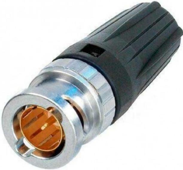
Il connettore per cavo BNC rearTWIST HD offre un design a 75 Ω ed è perfettamente adatto alle applicazioni ad alta definizione. L'alloggiamento brevettato rearTWIST garantisce un facile accesso anche in applicazioni ad alta densità e offre una codifica a colori. Cavi adatti: Belden 1855A, Clark Wire CD7523-7, CommScope 7538 Dimensioni dei morsetti: Pin: 1,6 mm (quadrato) Schermo: 4,53 mm (esagonale)
