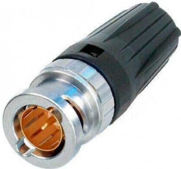
Il connettore posteriore TWIST HD per cavi BNC offre un design a 75 ° ed è perfettamente adatto per le applicazioni ad alta definizione. L'alloggiamento brevettato posteriore TWIST garantisce un facile accesso anche in applicazioni ad alta densità e offre una codifica a colori. Cavi adatti: Kansai 3C-5S, Proel HPC 820 Dimensioni dei morsetti: Pin: 1,6 mm (quadrato) Schermo: 5,0 mm (esagonale)
