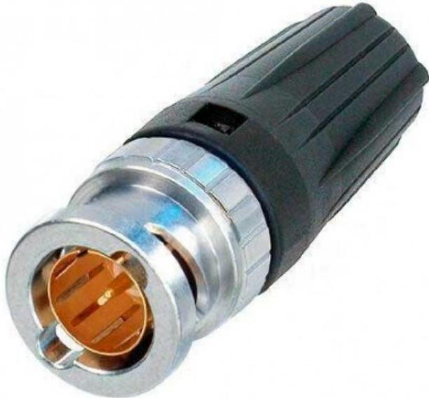
Il connettore per cavo BNC posteriore TWIST HD offre un vero design a 75 ° ed è perfettamente adatto alle applicazioni ad alta definizione. L'alloggiamento brevettato posteriore TWIST assicura un facile accesso anche nelle applicazioni ad alta densità e offre una codifica a colori. Cavo adatto: Canare V(3-5)-3CT dimensioni di crimpatura: Pin: 1,6 mm (quadrato) Schermo: 5,0 mm (esagonale)
