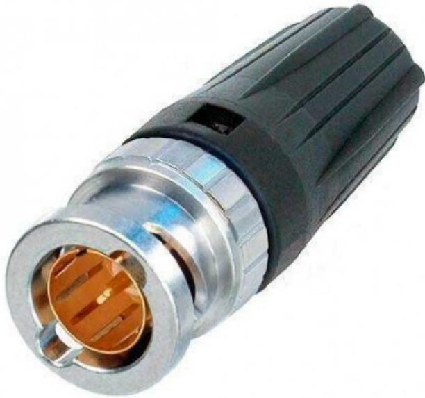
Il connettore posterioreTWIST per cavi BNC offre un design a 75 ? ed è perfettamente adatto per le applicazioni ad alta definizione. L'alloggiamento brevettato posterioreTWIST garantisce un facile accesso anche in applicazioni ad alta densità e offre una codifica a colori. Cavo adatto: Canare V(3-5)-4CFBC dimensioni dei morsetti: Pin: 1,6 mm (quadrato) Schermo: 5,41 mm (esagonale)
