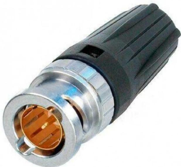
Il connettore posteriore TWIST HD per cavi BNC offre un vero design a 75 Ω ed è perfettamente adatto per le applicazioni ad alta definizione. L'alloggiamento brevettato posteriore TWIST garantisce un facile accesso anche in applicazioni ad alta densità e offre una codifica a colori. Cavi adatti: Belden 1695A, CommScope 2279VC. Dimensioni di serraggio: Pin: 1,6 mm (quadrato) Schermo: 6,47 mm (esagonale)
