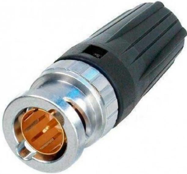
Il connettore posteriore TWIST HD per cavi BNC offre un vero design a 75 ° ed è perfettamente adatto per applicazioni ad alta definizione. L'alloggiamento brevettato posteriore TWIST garantisce un facile accesso anche in applicazioni ad alta densità e offre una codifica a colori. Cavi adatti: Canare V(3-5)-5CFB, Canford SDV-L, Canford SDV-F, Cordial CVI 10-48 HD-FRNC, Fuzion SD-1-LLS Dimensioni di impostazione: Pin: 1,6 mm (quadrato) Schermo: 7,01 mm (esagonale)
