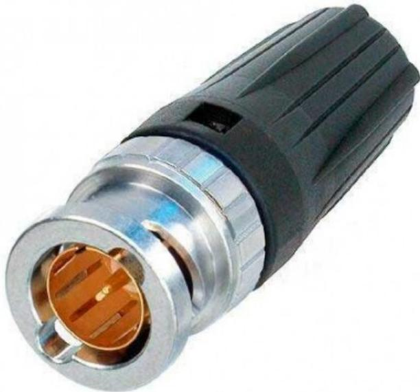
Il connettore per cavo BNC posteriore TWIST HD offre un vero design a 75 ° ed è perfettamente adatto alle applicazioni ad alta definizione. L'alloggiamento brevettato posteriore TWIST garantisce un facile accesso anche in applicazioni ad alta densità e offre una codifica a colori. Cavo adatto: Tesca Dublo, Tesca Vostok, Wisi MK 99 Dimensioni di regolazione: Pin: 1,6 mm (quadrato) Schermo: 7,01 mm (esagonale)
