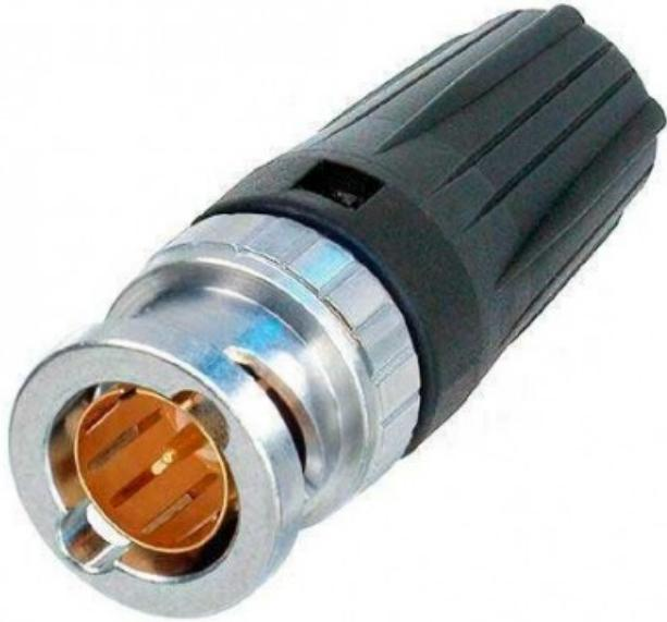
Il connettore per cavo BNC posterioreTWIST HD offre un vero design a 75 ? ed è perfettamente adatto alle applicazioni ad alta definizione. L'alloggiamento brevettato posterioreTWIST garantisce un facile accesso anche in applicazioni ad alta densità e offre una codifica a colori. Cavo adatto: CAE HD1250FLEX, CAE VCB 100 Dimensioni di crimpatura: Pin: 1,6 mm (quadrato) Schermo: 7,36 mm (esagonale)
