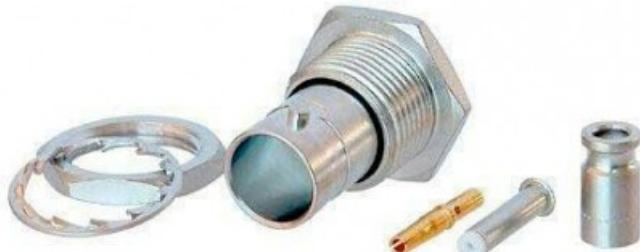
Connettori BNC femmina per montaggio a pannello, isolati.I connettori Neutrik BNC femmina per montaggio a pannello offrono un design a 75 ° per segnali seriali e digitali (HD). Il corpo del connettore in ottone lavorato fornisce una connessione estremamente robusta e non abrasiva durante l'uso a lungo termine.Cavi adatti:Draka 0,41/1,9 AF, Draka 753-1104, Draka 755-1101, Draka 755-1103, Extron BNC 5 HR(P) (sfuso)Dimensioni della crimpatura:Pin: 1,6 mm (quadrato)Schermo: 4,53 mm (esagonale)
