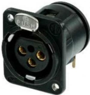
Presa femmina a 3 poli, montaggio orizzontale su circuito stampato, corpo in metallo nero, contatti placcati oro, fori di montaggio M3. Serie universale per montaggio a pannello in formato D con corpo in metallo per applicazioni di montaggio su circuito stampato. L'inserto è rimovibile dal corpo per facilitare il montaggio. Componente riconosciuto UL.
