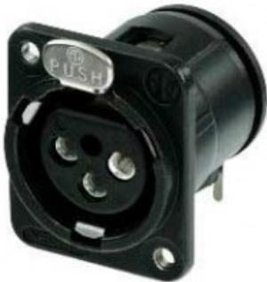
Connettore femmina a 3 poli, montaggio orizzontale su PCB, corpo metallico nero, contatti argentati, fori di montaggio M3. Serie XLR per montaggio a pannello con corpo metallico di dimensioni universali per applicazioni di montaggio su PCB. L'inserto è rimovibile dal corpo per facilitare il montaggio. Componente riconosciuto UL.
