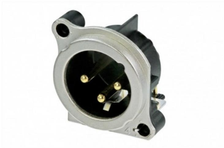
Preso XLR maschio a 3 poli, messa a terra: contatto di terra separato per l'alloggiamento del connettore e il pannello frontale, capocorda di fissaggio in acciaio, montaggio orizzontale su scheda, contatti di terra aggiuntivi. Come la serie A, con l'eccezione di una flangia di montaggio in metallo che presenta un contatto di terra circolare continuo con lo chassis per una migliore pratica EMC. Componente riconosciuto UL.
