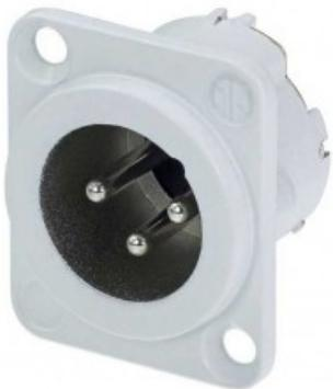
Presa maschio a 3 poli, con terminali a saldare, alloggiamento verniciato bianco, contatti argentati. La serie DLX è caratterizzata da un alloggiamento compatto interamente in metallo con un intelligente contatto di terra duplex, che offre un'eccellente schermatura e protezione RF. È la combinazione ideale per il collegamento con il connettore Neutrik EMC XLR.
