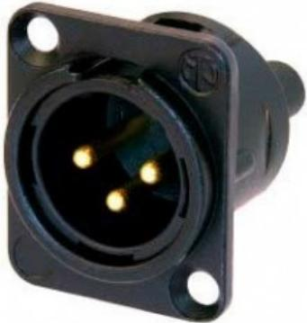
Presa maschio a 3 poli, corpo metallico di dimensione D, terminali a vite che supportano una gamma di fili da 0,14 mm<sup>2</sup> a 0,5 mm<sup>2</sup> (AWG 26-20), corpo metallico nero, contatti placcati in oro, componente riconosciuto UL.
