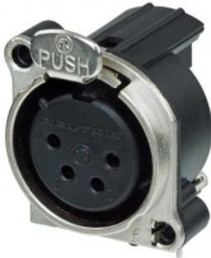
Connettore XLR femmina a 4 poli, messa a terra: contatto di terra separato con l'alloggiamento del connettore e il pannello frontale, montaggio orizzontale su scheda, come la serie A, con l'eccezione di una flangia di montaggio in metallo che presenta un contatto di terra circonferenziale continuo con lo chassis per una migliore pratica EMC.
